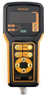
Предназначен для измерения малых значений напряжения, сопротивления, а также температуры с высокой точностью. Может применяться для контроля контактного сопротивления, напряжения и температуры с термопар, температуры с внешних термометров сопротивления и т.д.
